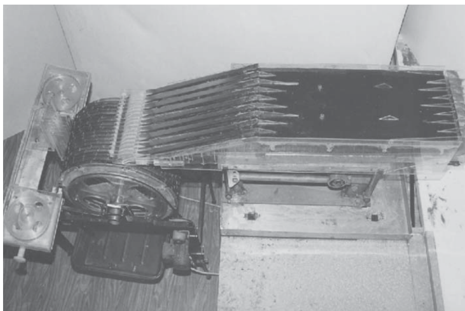
Rys. 1. Przykład maszyny do szeregowej obróbki ryb – nobbingarka firmy Baader
