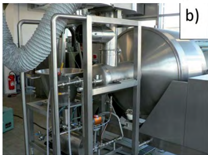
Rys. 6. Masownica przystosowana do coatingu: a) schemat b) widok.
