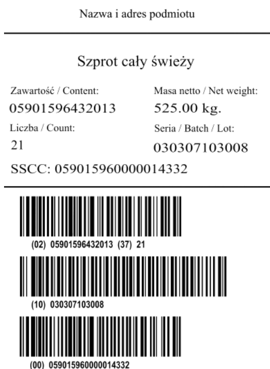
Rys. 1. Etykieta logistyczna z kodem kreskowym GS1-128.
