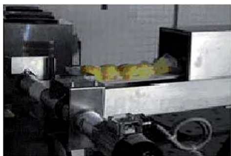
Rys. 3. Tunelowy system do mikrofalowego podgrzewania żywności w workach foliowych [www.sairem.com].
