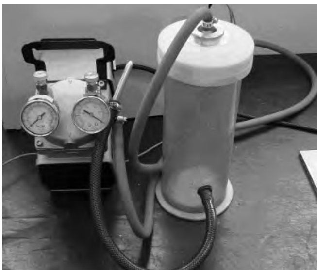
Rys. 4. Stanowisko do patroszenia podciśnieniowego.
