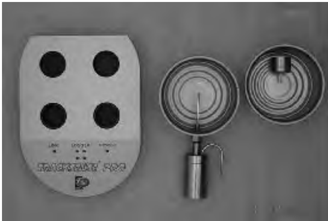
Rys. 1. Sposób umieszczenia czujników pomiarowych (logerów).
