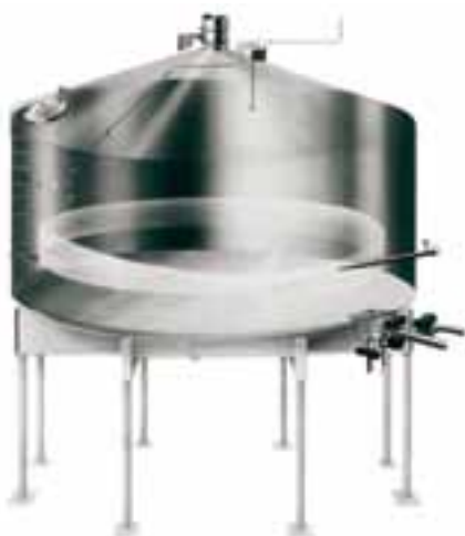
Rys. 1. Widok ogólny klasycznej konstrukcji kadzi wirowej [3].
