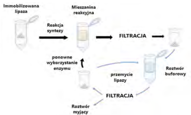
Rys. 3. Proces regeneracji z zastosowaniem roztworu buforowego.
