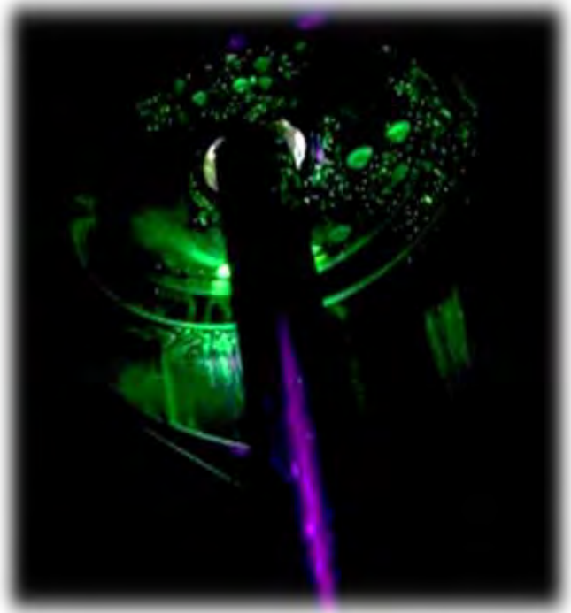
Rys. 3. Wybrany punkt kontrolny ZB_{m-2} – Wał mieszadła i osadzenie wału – Niepełne wypłukanie ryboflawiny [fotografia własna].
