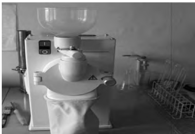
Rys. 2. Zdjęcie przedstawiające, śrutownik LAB MILL 120 firmy PERTEN, [Foto, J. Rut, K. Szwedziak].
