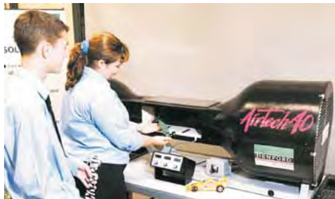
Rys. 5. Badanie modeli F1 w tunelu aerodynamicznym [3].
