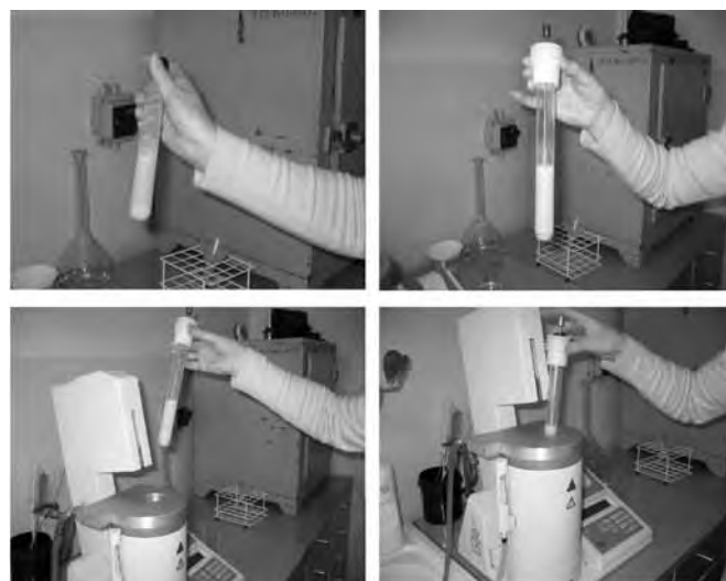
Rys. 4. Zdjęcia przedstawiające przygotowanie próbki do analizy na liczbę opadania, [Foto, J. Rut].
