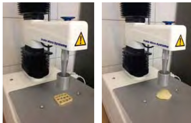
Rys. 2. Oznaczenie tekstury za pomocą teksturometru TA.XT Plus.
