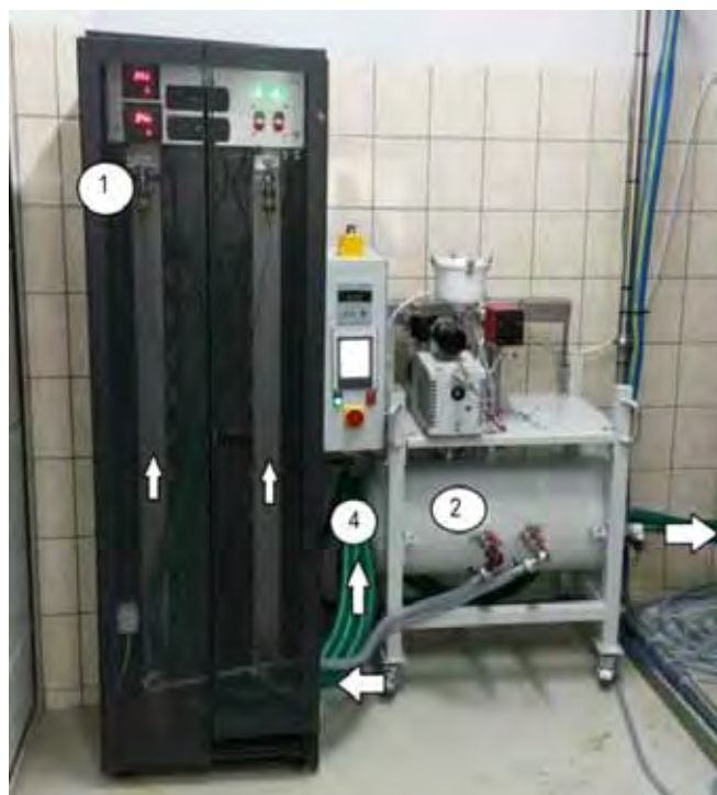
Rys. 5. Schemat wytwarzania wody zdeklastrowanej. Fig. 5. Scheme for preparing nano water.
