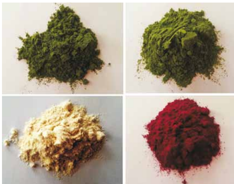
Rys. 1. Proszki warzywne otrzymane metodą suszenia niskotemperaturowego z równoczesną mikronizacją stanowiące materiał badawczy: a) koperek, b) pietruszka, c) kapusta, d) burak.
