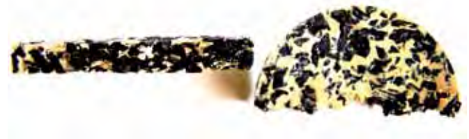
Rys. 5. Widok rozkładu granulatu gumowego w kompozycie.
