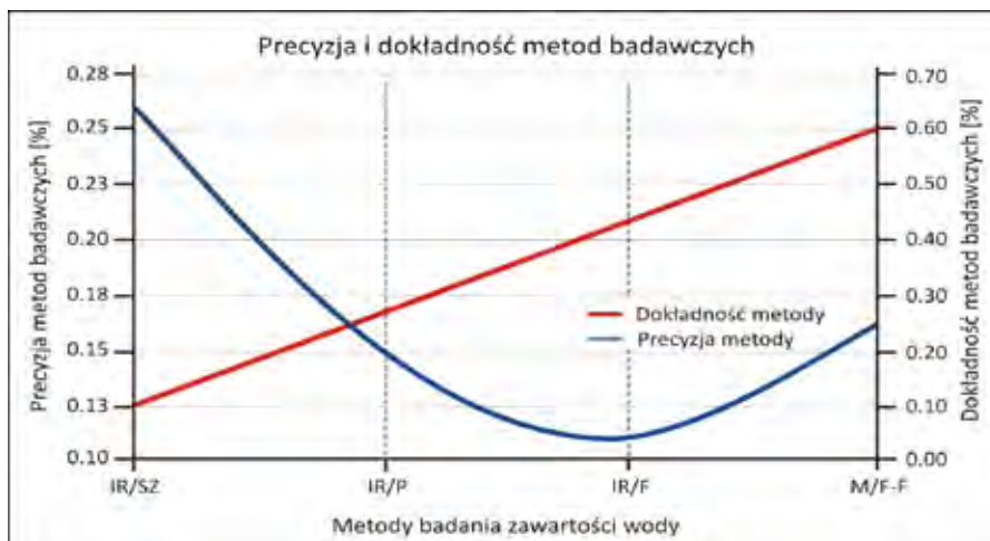
Rys. 3. Dokładność i precyzja metod badania zawartości wody.
