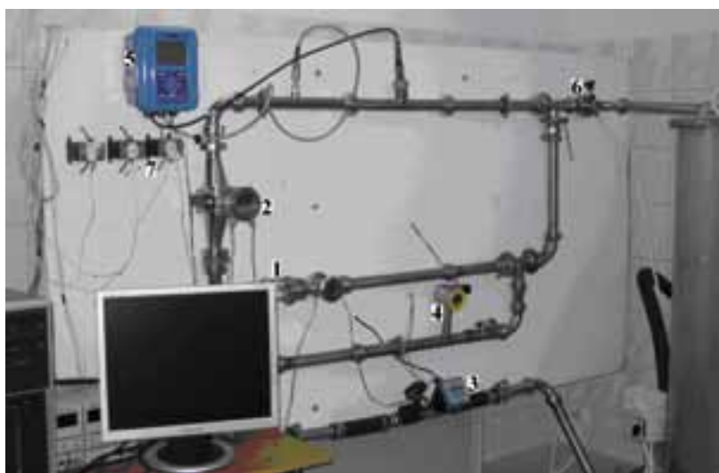
Rys. 1. Aparatura laboratoryjnej stacji do mycia w przepływie: 1. Elementy kontrolne brudzone i myte, 2. Mętnościomierz, 3. Przepływomierz, 4. Ciśnieniomierz, 5. Pomiar przewodności i pH, 6. Zawór dławiący, 7. Zestaw do pomiaru parametrów zasilania.
