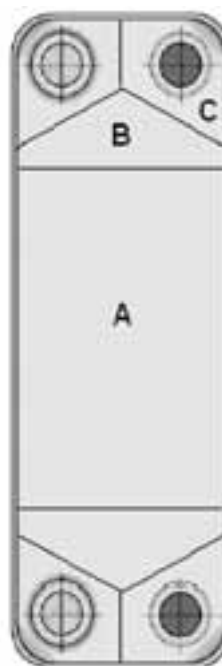
Rys. 1. Główne części płyty w wymienniku ciepła.
