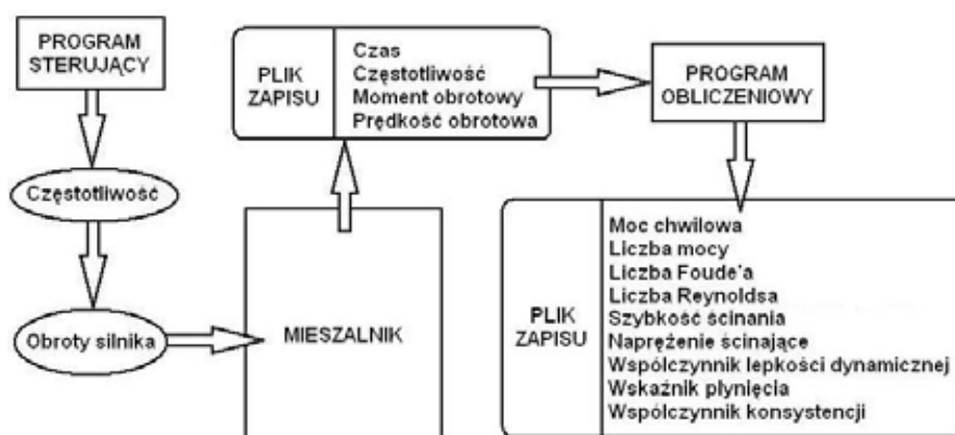
Rys. 3. Schemat przepływu i przetwarzania danych na stanowisku badawczym do mieszania nieniutonowskich płynów spożywczych.
