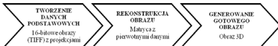
Rys. 2. Etapy powstawania obrazu w mikrotomografie komputerowym. Fig. 2. Stages of image formation in a computer x-ray microtomography.
