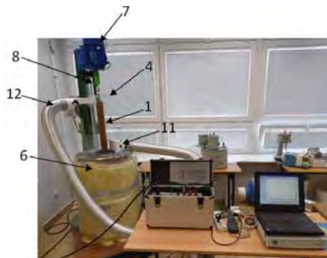
Rys. 2. Konstrukcja prototypu urządzenia do zagęszczania miodu w trakcie pracy.
