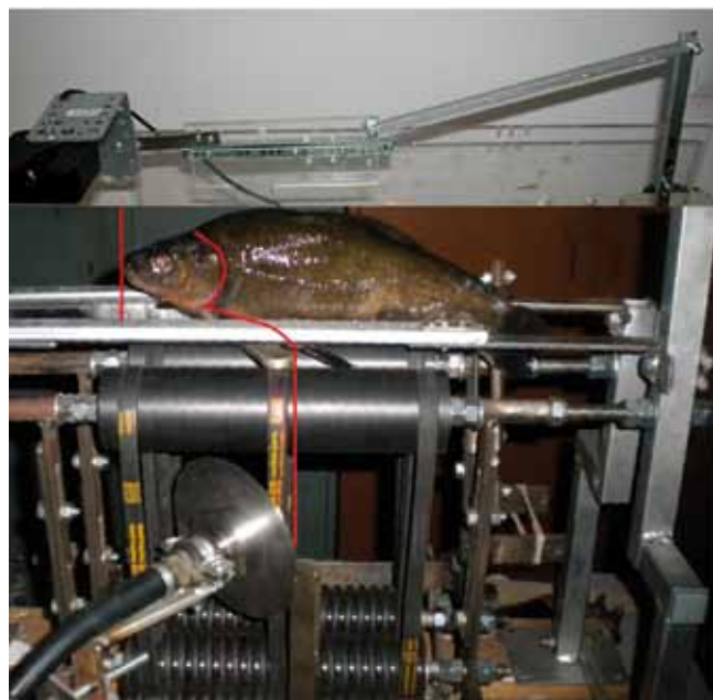
Rys. 3. Model badawczy klinowego odgławiania i wycinania kręgosłupów ryb różnych gatunków, w którym stosowane jest ich pozycjonowanie według linii świetlnej lasera (czerwona) i pomiar długości głowy przy pomocy czujnika fonicznego.
