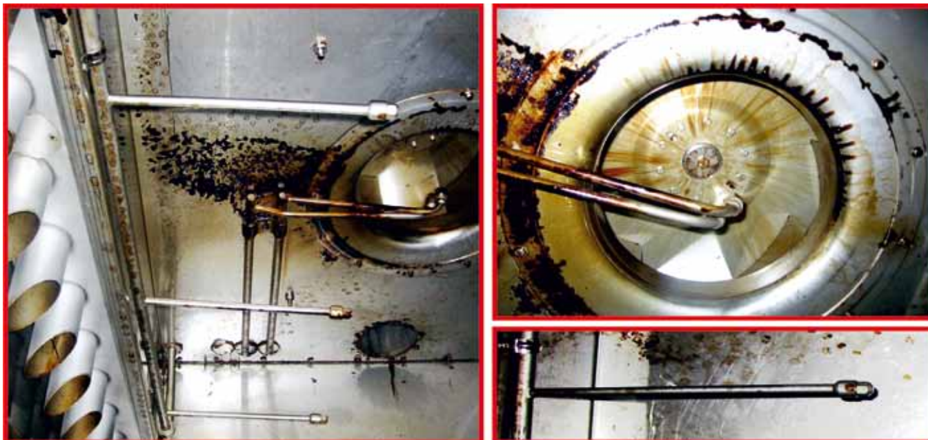
Fot. 1. Układ głowic pianotwórczych wewnątrz komory wędzarniczej pod sufitem i wentylatorem.
