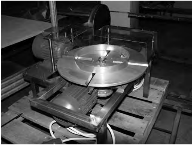
Rys. 7. Model urządzenia do odcinania odpadów po filetowaniu części kręgosłupa wraz z nerką.
