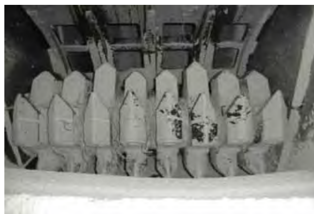
Rys. 4. Wnętrze kruszarki Brieden z widocznymi zanieczyszczeniami.
