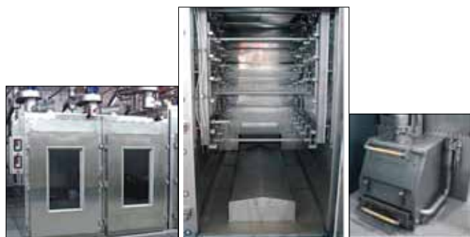
Rys. 4. Komora do tradycyjnego wędzenia: A-widok zewnętrzny; B-widok wewnętrzny; C-palenisko.
