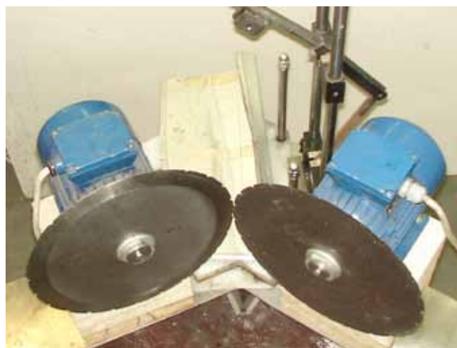
Rys. 2. Model II urządzenia odgławiającego cięciem okołoskrzelowym z przemieszczaniem ryby względem noży odgławiających – załadunek ryby na nieckę pod nożami.
