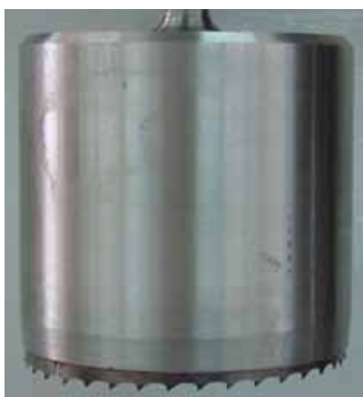
Rys. 4. Nóż cylindryczny do odgławiania cięciem okołoskrzelowym po łuku.
