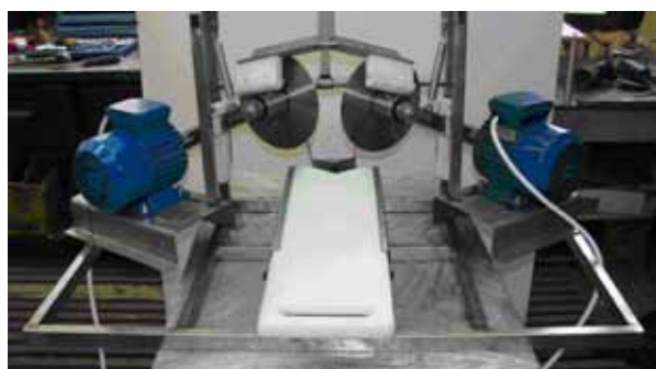
Rys. 1. Model I urządzenia odgławiającego cięciem okołoskrzelowym z przemieszczaniem noży odgławiających względem ryby.
