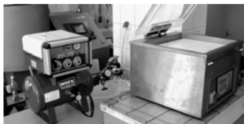
Rys. 2. Stanowisko badawcze: a) od lewej mieszalnik gazów KM100Mem ze zbiornikiem, butle i armatura gazowa, pakowaczka próżniowa PP 5.4, b) analizator gazu typu OXYBABY firmy WITT.
