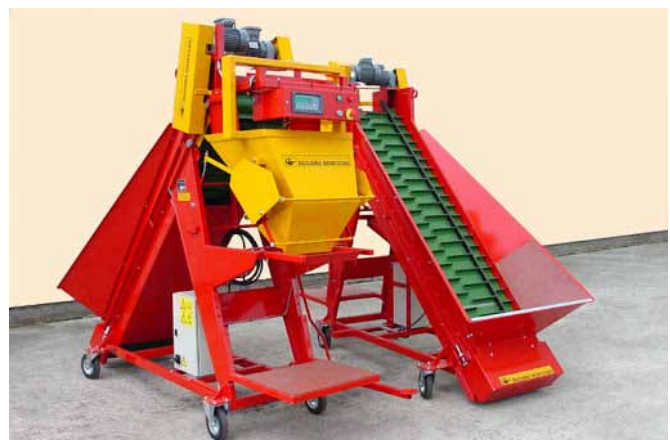
Fig. 3. Double-belt weighing-packing machine by Biljsma Hercules. Rys. 3. Wagoworkownica dwutaśmowa firmy Biljsma Hercules.
