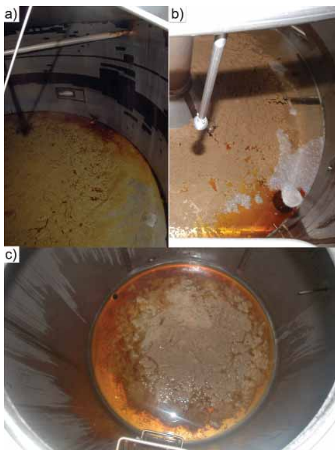
Rys. 2. Postać osadu gorącego po opróżnieniu zbiornika po wirowaniu brzezki o pojemności wybijcia: a) 1050 hl; b) 520 hl; c) 30 hl [6].
