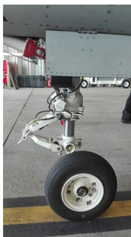
Zdj. 3. Wysunięcie amortyzatora przedniego podwozia 28 sprawdzane w trakcie obsługi bieżących
