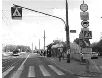
Fot. 2. Zestaw znaków na początku zamkniętej dla samochodów części jezdni ulicy Al. Solidarności
